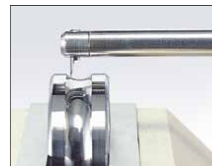
轴承的内圈/外圈轮廓
