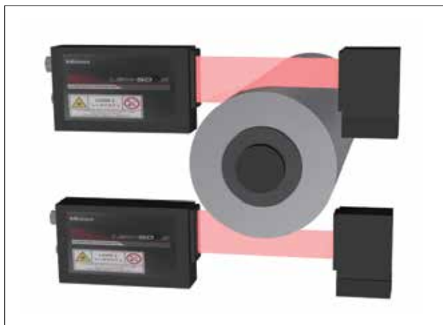
测量超大外径的双机测量系统
