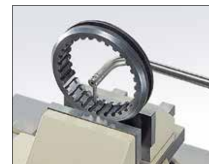
内齿轮齿形测量
