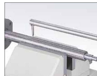
外螺纹形状测量
